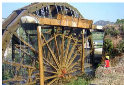
Una noria movida por energía hidráulica, la del agua que corre por un río.
